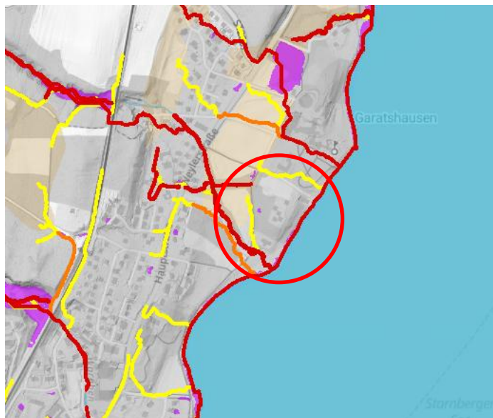
Abb. 9 Potentielle Fließwege bei starkregen, Geländesenken und potentielle Aufstaubereiche, Plangebiet (roter Kringel), ohne Maßstab, Quelle: Umweltatlas, Stand 05.06.25
